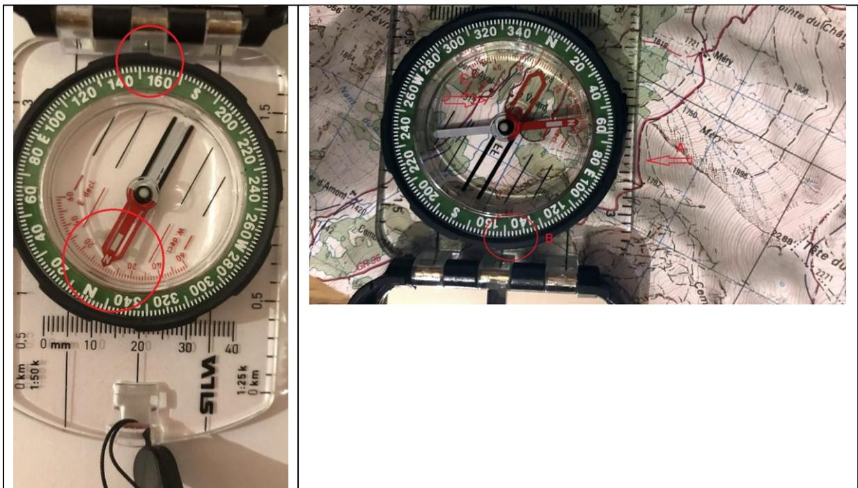
Sur l’image de gauche (simulation) on fait la mesure sur le terrain en orientant la réglette vers le sentier de droite en maintenant le **rouge de l’aiguille** sur le nord du cadran : on obtient 150°.
